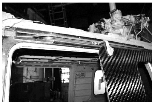
Рис.2. Элементы сдвижной двери, вклеенные с применением полиуретанового герметика в проем фюзеляжа
