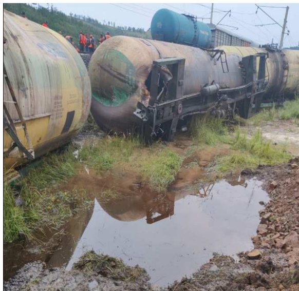
Фотографии места разлива нефтепродуктов при опрокидывании вагонов в результате столкновения поездов на участке Алеур-Бушулей
